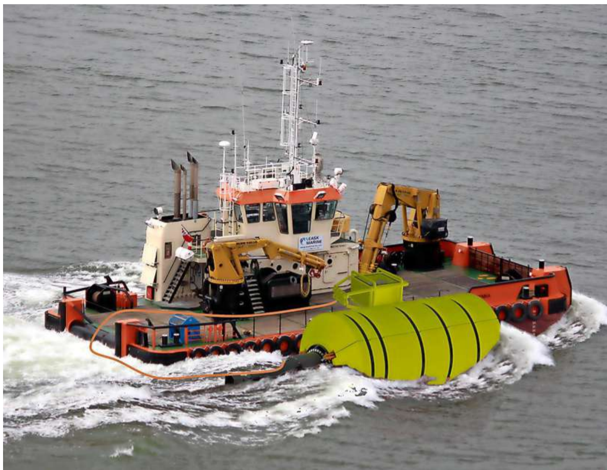
Een werkboot brengt een 'laadpaal' naar zee waar het gevaarte rechtop wordt gezet in de zeebodem
